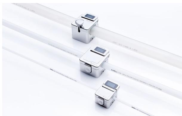
Clamp-On-Sensoren der Serie SONOFLOW CO.55 V3.0 messen den Durchfluss von Flüssigkeiten in flexiblen Schläuchen mit unterschiedlichen Durchmessern. Mit hoher Genauigkeit, Reproduzierbarkeit und Wiederholbarkeit – auch bei kleinsten Durchflüssen – sind sie für eine Vielzahl von Anwendungen geeignet. Umfangreiches Zubehör ermöglicht die unkomplizierte Integration in ganz unterschiedliche Prozessumgebungen.
