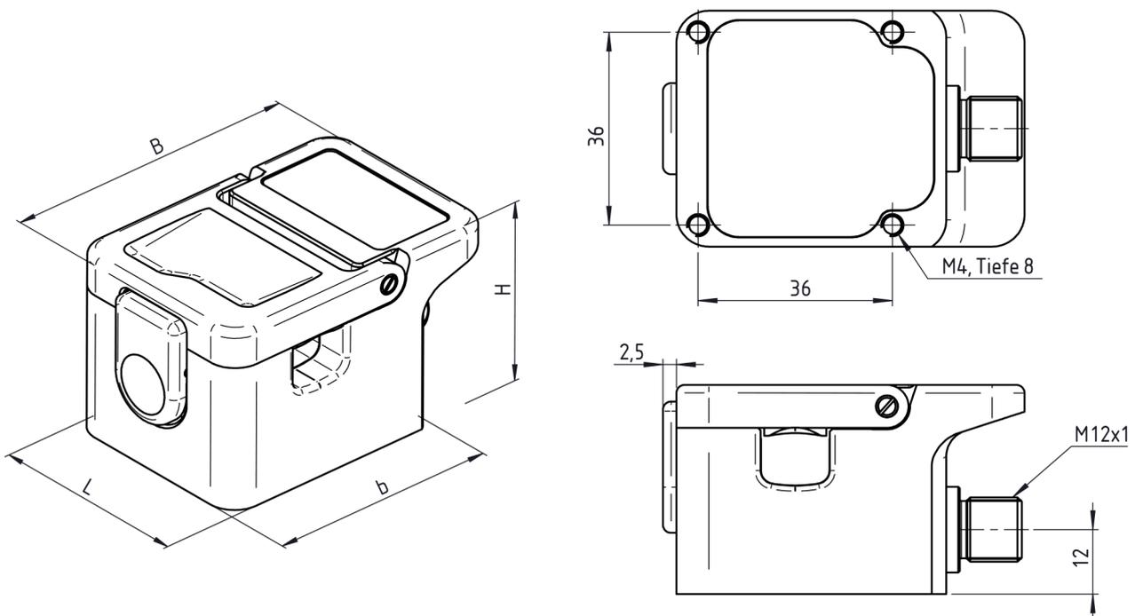
Sensorvariante mit Schnappverschluss: mittlere Bauform
